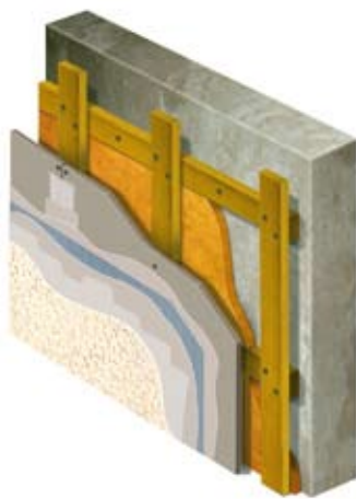
Система с вентилиране на фасадата
